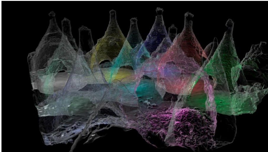
Exemple de relevé LiDAR d'une carrière en catiches (données SCCS)
